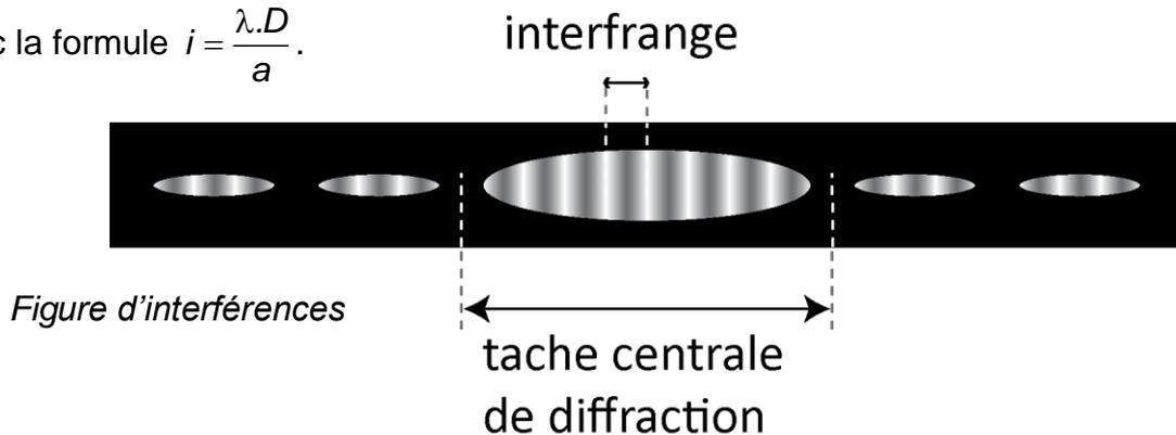
$a$  est la distance entre deux fentes,  $\lambda$  est la longueur d'onde dans le vide de la lumière monochromatique,  $D$  est la distance entre la double fente et l'écran où apparaît la figure d'interférences.
