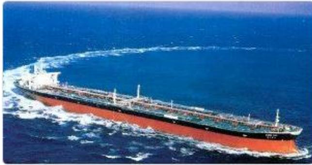
Traduction : « La quantité de mouvement peut être considérée comme une mesure de la difficulté à stopper un système. Les pétroliers supertankers font partie des choses les plus difficiles à arrêter avec plus de  $5,6 \times 10^{12}$  kg.m/s. Ils utilisent l'eau pour cela, coupant leurs moteurs 25 km avant le port. »
